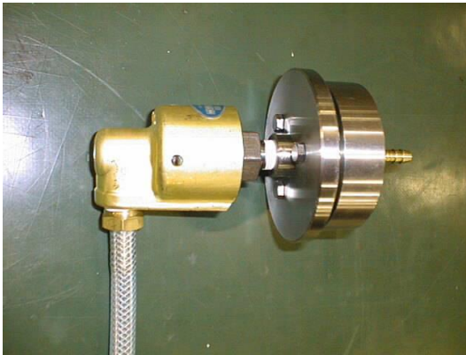
汎用旋盤で使用したロータリージョイント
