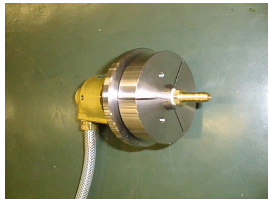
汎用旋盤で使用したロータリージョイント
